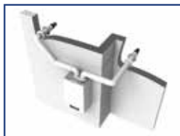
Рисунок 1.3.3 Максимальная эквивалентная длина: 10 м
